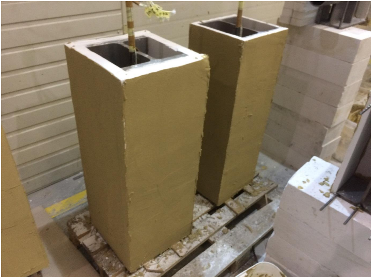
Rysunek 2. Płyty Novoper 60mm zamontowane na słupie stalowym, połączenie narożne proste.
